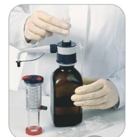
2. На стерильной поверхности снимите крышку, присоедините новый стерильный картридж и пружинный блок
